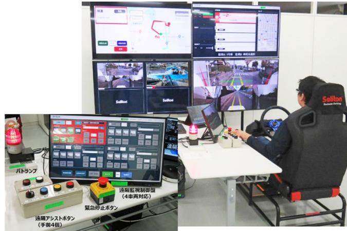
図 2. 遠隔アシスト用操作ボタン(左ボタン 4 個)
